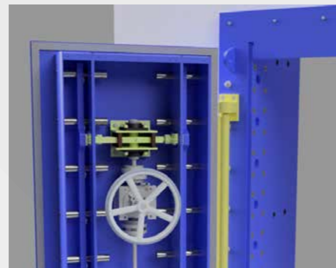
15 bar blast door
